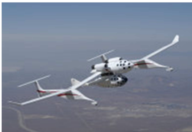
Obrázek 1: SpaceShipOne, první soukromé letadlo, které uskutečnilo let na hranice atmosféry (2004). Oxid dusný byl využit jako oxidovadlo v raketovém motoru.
