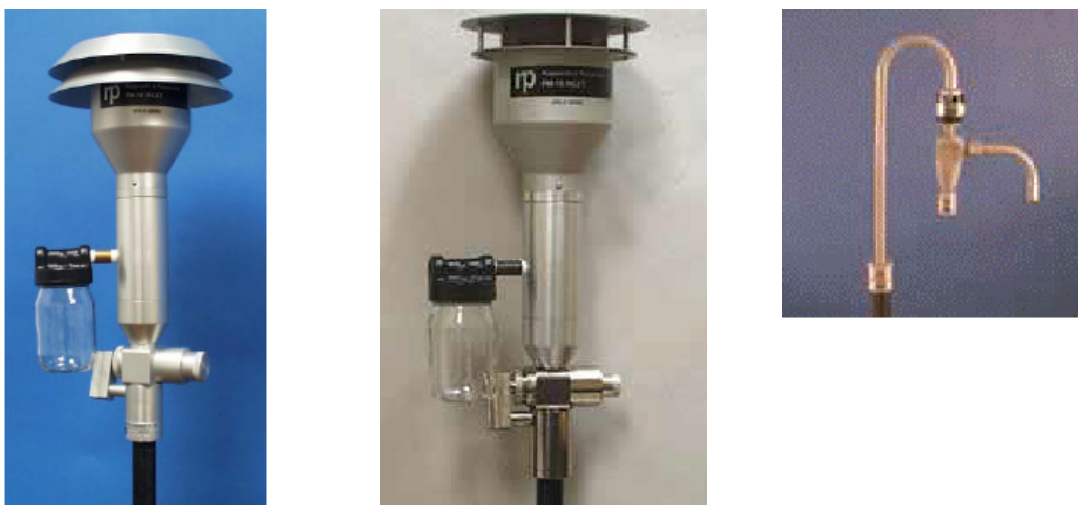
Obrázek 6 Příklady konstrukce vstupních hlavic vzorkovacích zařízení PM 10 (Compendium of methods for Organic Compounds US EPA 1999)
