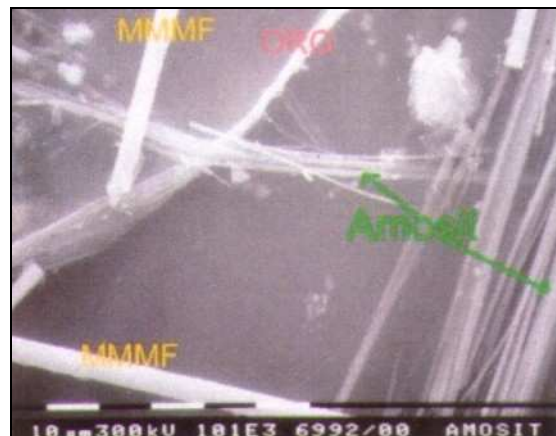
Amosit v prachových částicích, zvětšení 1000 x. MMMF jsou syntetická vlákna, ORG – organická vlákna. SEM
